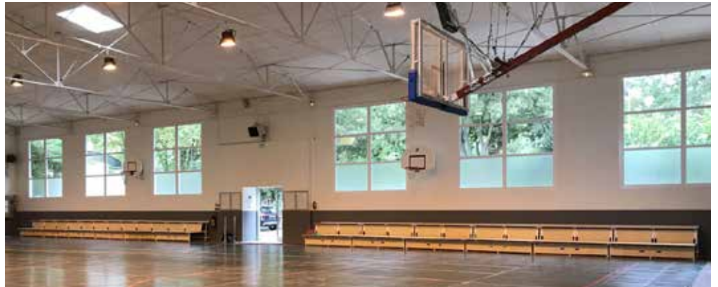
Assises contreplaqué classé au feu M2 épaisseur 18 mm. Verni multicouche, tous bords arrondis et chanfreiné. Pour les versions « piscines » les panneaux sont peints avec une peinture polyuréthane.
