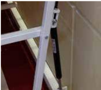
Vérin à gaz pour l'assistance au levage et à la mise en place de la tribune.
