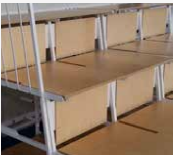
Marché-pieds en contreplaqué 18 mm. Contre-marche et panneaux frontaux en contreplaqué 8 mm.
