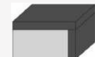
Mousse double densité, une couche principale souple et une couche rigide
