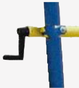
Système de réglage de l'écartement des barres très précis par manivelle.
