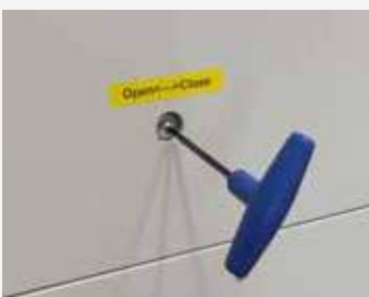
Clé de fermeture et de blocage en position de rangement.
